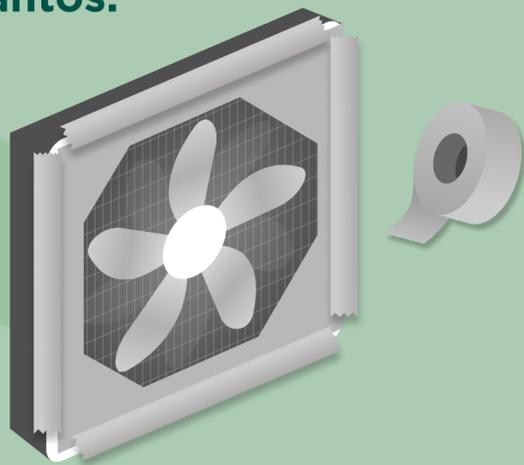
5. Coloque a fita adesiva nos cantos da frente do ventilador. Meça 5.3" da extremidade externa.
